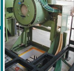
Las máquinas de colada continua vertical HORMESA - Conticast® RIN son usadas para la fabricación de barras, tubos y secciones de bronce v latón.
