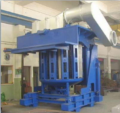
Horno de Inducción de 12Ton de capacidad, con estructura de acero y núcleos magnéticos.
