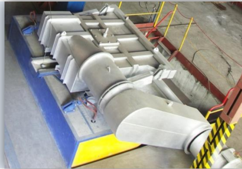
Cubierta hidráulica para hornos de alta capacidad, con accionamiento hidráulico y campana extractora de humos.
