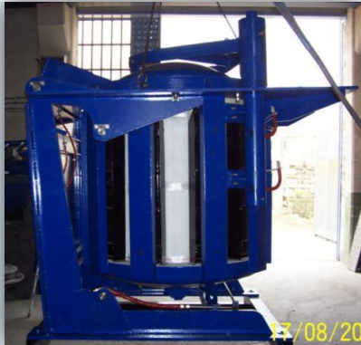
Horno de Inducción de 750Kg de capacidad, con estructura de acero y núcleos magnéticos.
