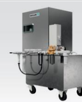
Sistema de mezcla y dosificación de agente separador con bomba sumergible aguas abajo.
